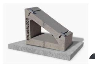
El sistema Solarbloo® permite fijar los módulos solares directamente al soporte sin utilizar estructura metálica. Los soportes Solarbloo® se fabrican en siete grados distintos, 10°,12°,15°,18°,28°,30° y 34°.
